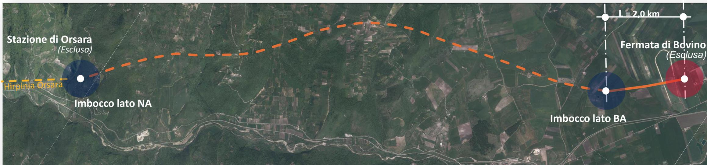
9877 m di lunghezza complessiva di cui 9288 m di galleria naturale in scavo meccanizzato con TBM
